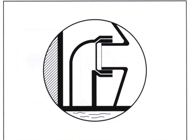
Şekil 25.12. YAN ÇIKIŞLI KLOZET MONTAJI DETAYI
