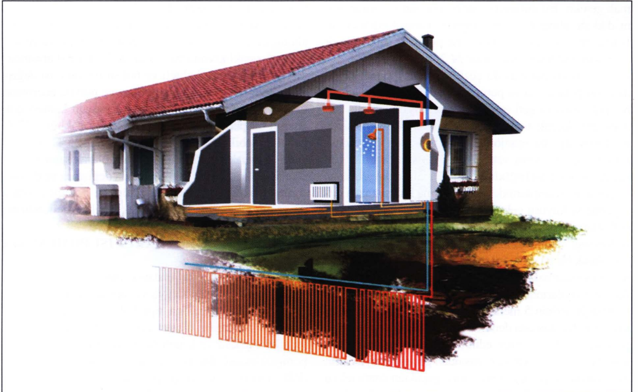
Şekil 14.20. HAVA/TOPRAK KAYNAKLI İKİZ ISI POMPASI
