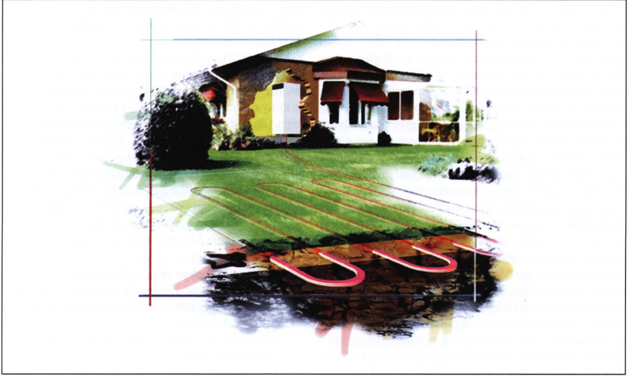
Şekil 14.23. TOPRAK KAYNAKLI ISI POMPASI TOPRAK KOLEKTÖRÜ UYGULAMASI
