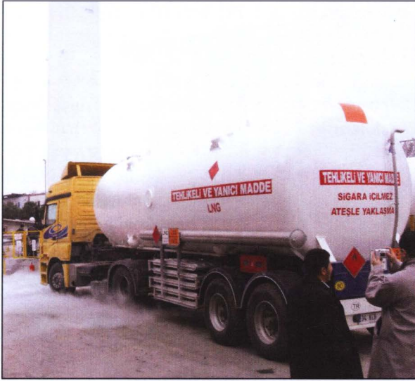
Şekil 22.53A. LNG KARA TANKERİ DEPOLAMA TANKINA DOLUM YAPIYOR.
