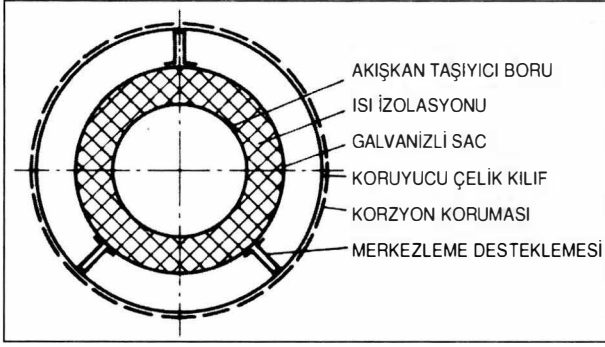
Şekil 4.21 / ÇELİK KORUYUCU BORULU KIZGIN SU BORUSU
