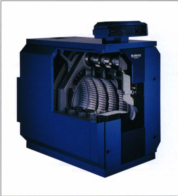
Şekil 2.8. SIVI/GAZ YAKITLI DÜŞÜK SICAKLIK KAZANI G 515 KAZAN GRİ DÖKÜMDEN, DİLİMLİ KONSTRÜKSİYONDA THERMOSTREAM TEKNIĞİNE SAHİP OLARAK İMAL EDİLMİŞTİR.
