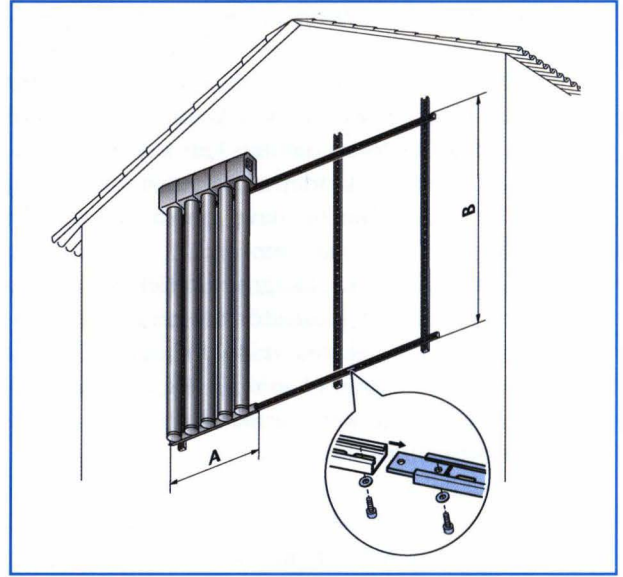
Şekil 141. İKİ LOGASOL VDR1.0 VAKUM BORULU KOLLEKTÖR (VRK) İÇİN DUVAR ASKI MONTAJ SETİNE EK TEK KOLLEKTÖR İLAVE SETİ (Mavi ile gösterilmiştir)
