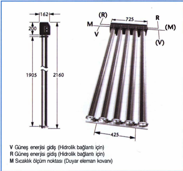
Şekil 13. VAKUM BORULU LOGASOL VDR 1.0 GÜNEŞ KOLEKTÖRÜNÜN BOYUTLARI
